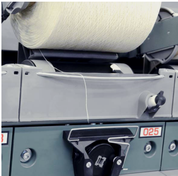
图3 快速纺纱 (FSI) 功能使纱头清晰可见。去除卷装内的纱疵变得更加容易。
