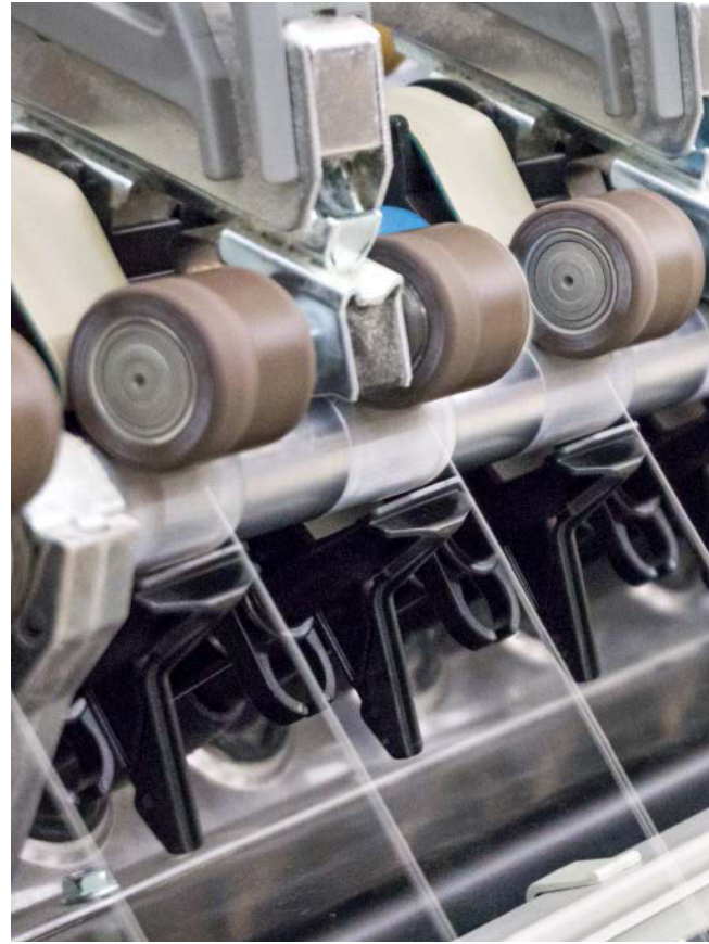
图2 ECOrized吸棉笛管降低环锭细纱机的能耗约10 %。
