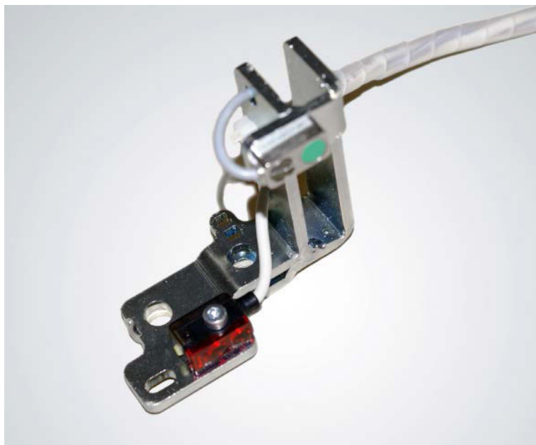
图2 B200驱动带监测器（左下）和非接触式B2 EVO+速度传感器（右上）能确保旧一代并条机生产出优质条子。
