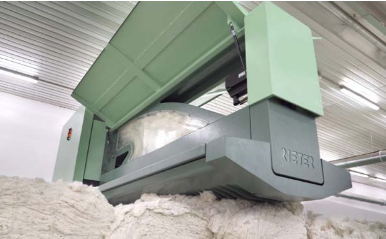
Fig. 2 Elevada producción tras el cambio de grupos de balas, gracias al barrido de balas patentado.
