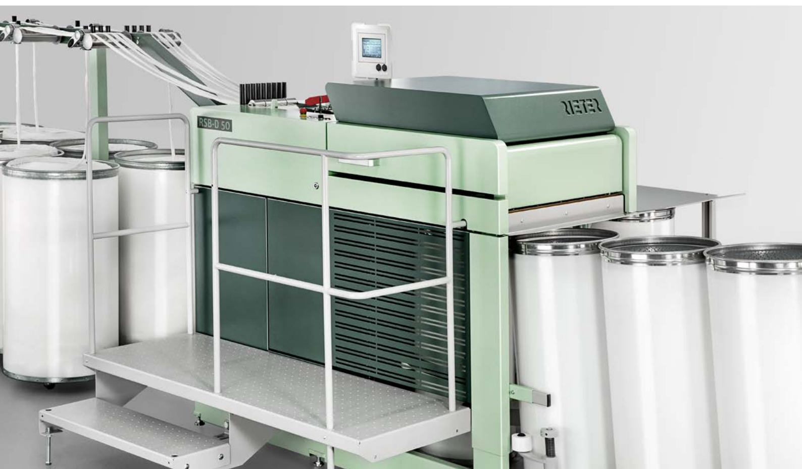
Fig. 1 Manuar RSB-D 50 – máxima productividad con 1 200 m/min de velocidad de entrega.
