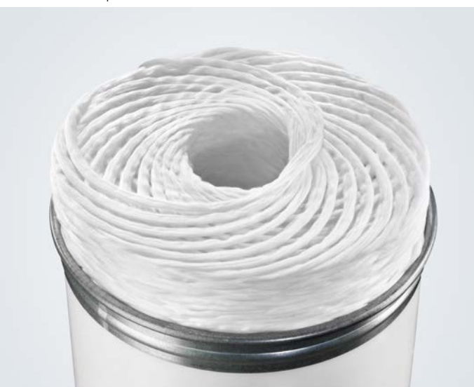
Fig. 5 Deposición limpia de cintas de poliéster gracias al plato giratorio CLEANcoil-PES.
