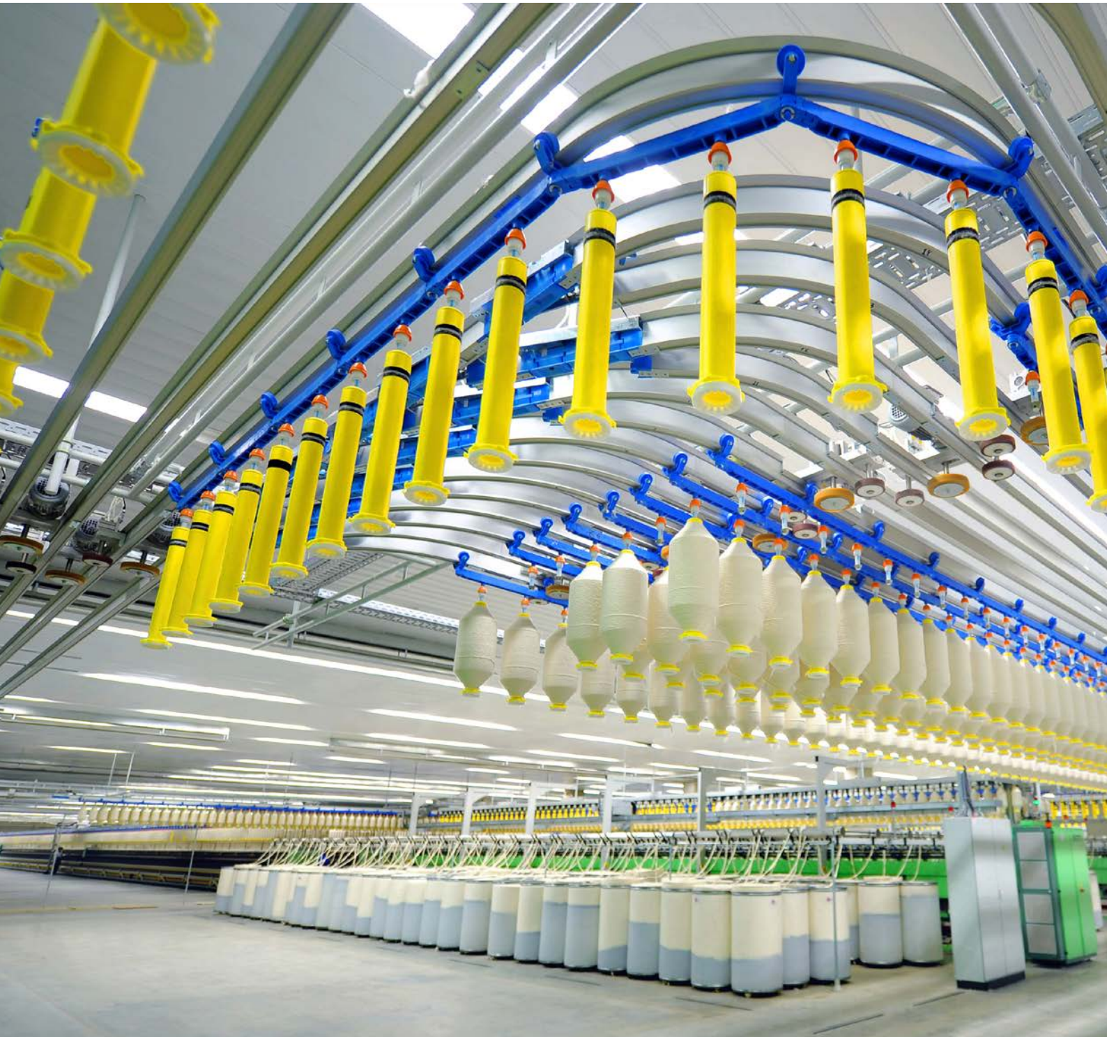
Fig. 1 Sistema de transporte de bobinas de mecha SERVOfail – para hilanderías eficientes y conscientes de calidad.
