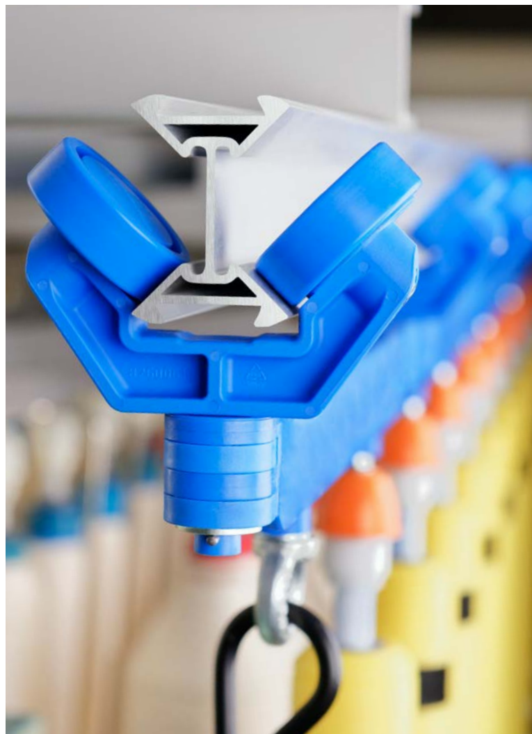
Fig. 4 Las superficies inclinadas de marcha del perfil de aluminio evitan suciedades y son libres de mantenimiento.
