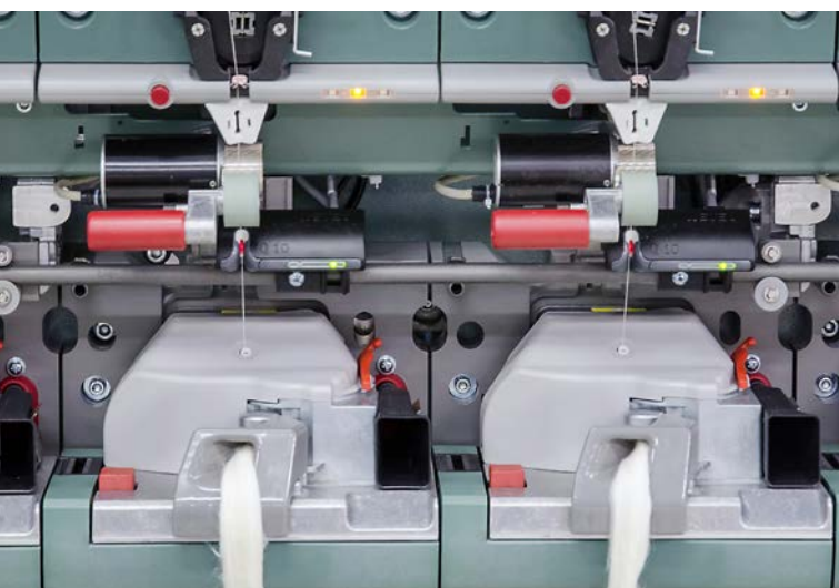
Fig. 2 La caja de hilado modernizada S 36 permite una resistencia mayor del hilo y menos imperfecciones.
