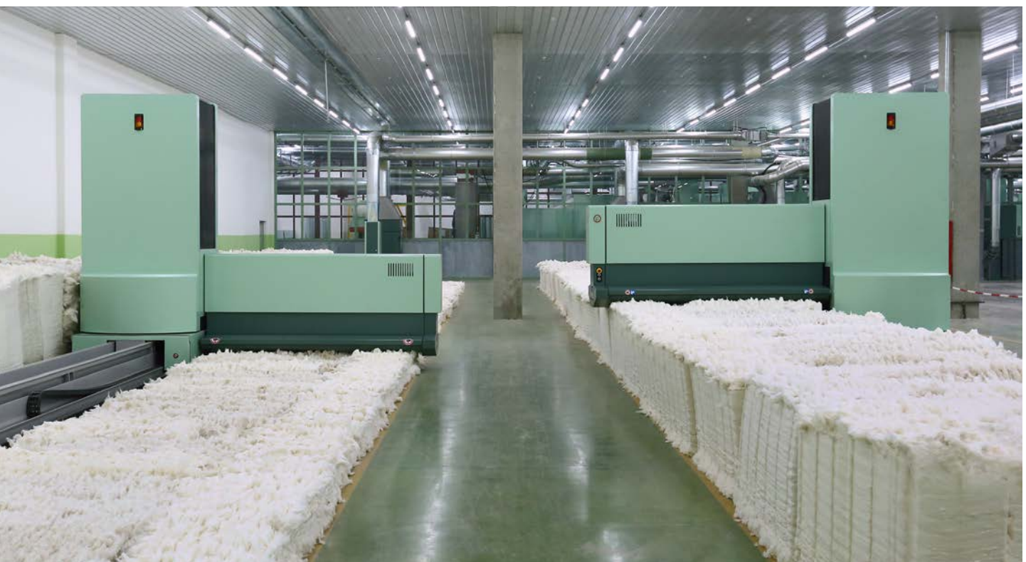
Fig. 1 UNIfloc A 12 – la forma moderna y eficiente de deshacer balas en microcopos.
