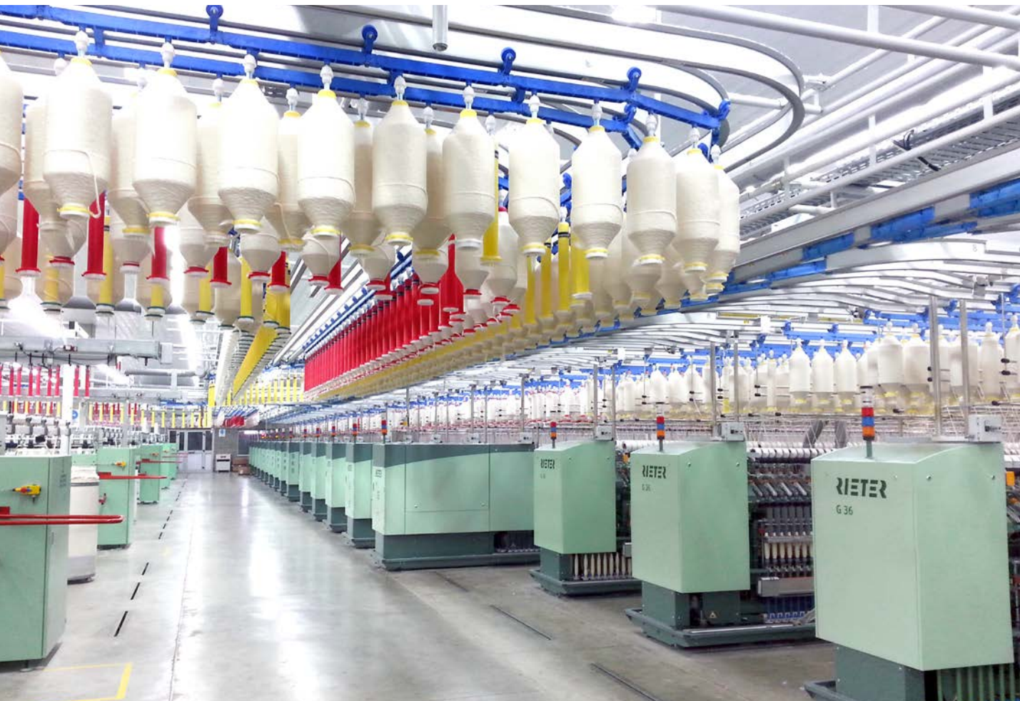
Fig. 3 Un transporte perfecto, sin contacto de bobinas garantiza una calidad constante.
