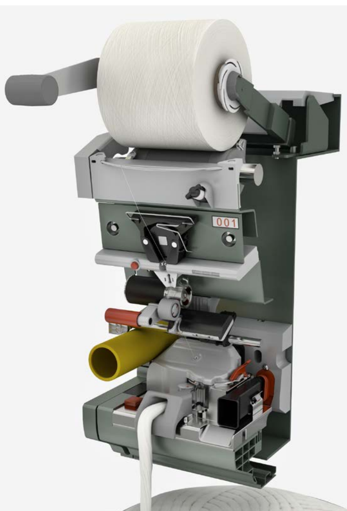
Fig. 4 AMIspin es el sistema para excelente calidad de empalme. Con la tecnología AMIspin-Pro opcional es posible alcanzar una calidad aun mejor con un manejo aun más sencillo.
