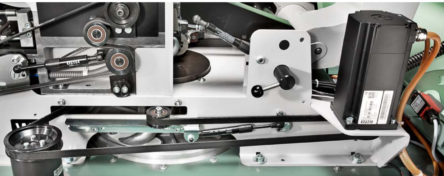
Fig. 2 El servomotor del plato giratorio permite una optimización rápida de la velocidad.
