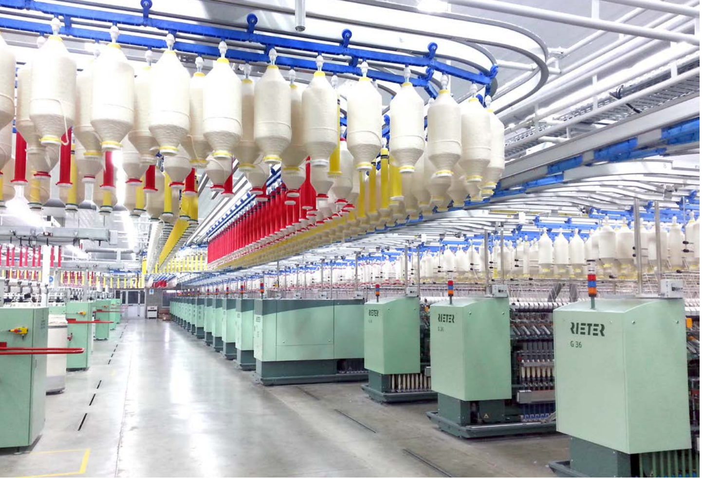
Şekil 3 Temasız materyal transportu sabit iplik kalitesini garanti eder.
