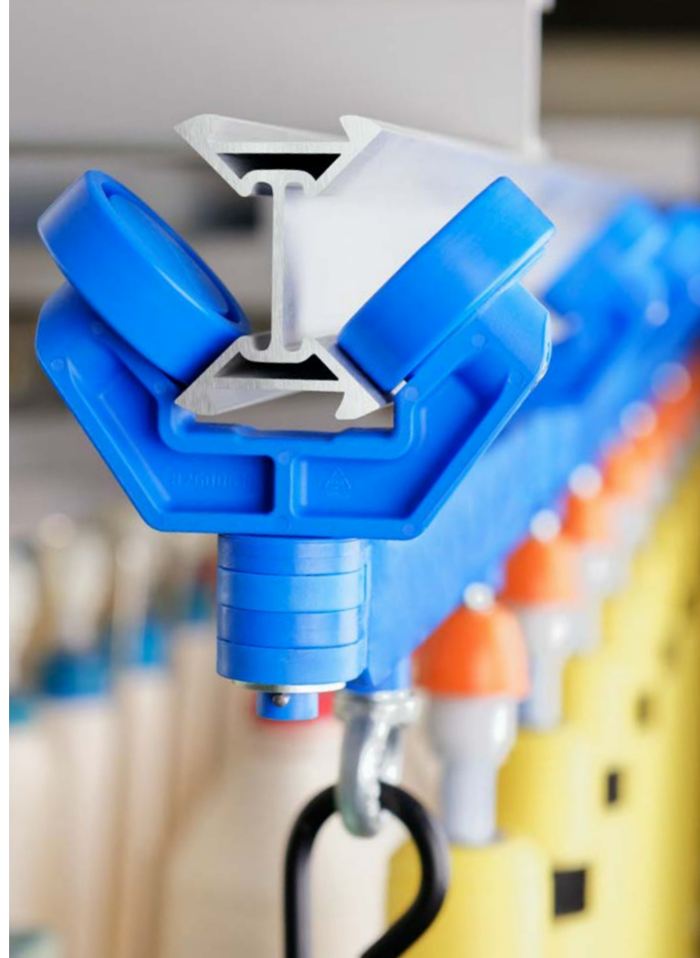
Şekil 4 Alüminyum profilin eğik kayar yüzeyleri kirlenmeyi önler ve bu sayede bakım gerektirmez.
