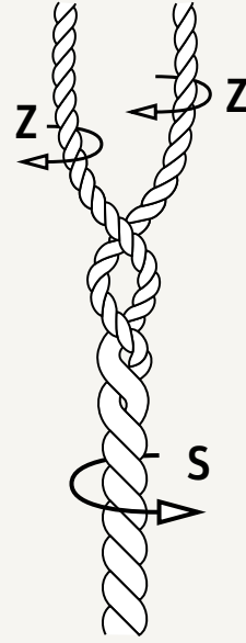
Şek. 5: İp örneği: İki Z bükümlü iplikten bir S bükümlü iplik üretilir.
