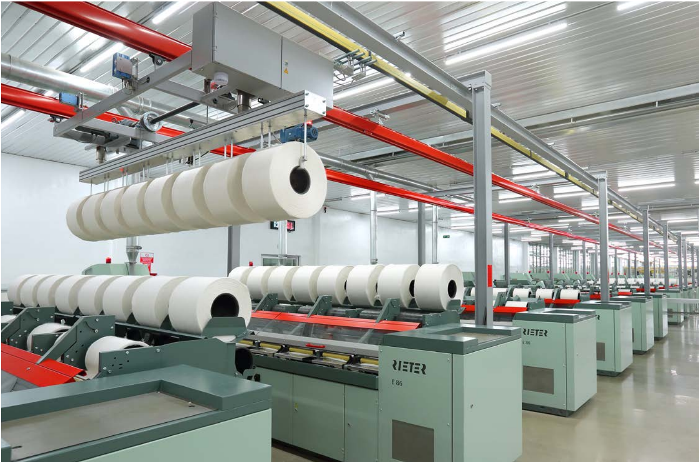
Şek. 1: E 26, vatkaları OMEGAlap E 36'dan iplik makinalarına etkili şekilde taşır ve çok az yer kaplar.
