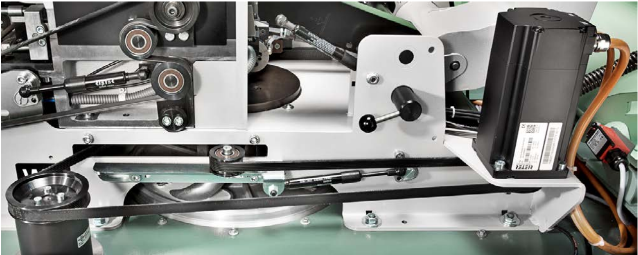
Abb. 2: Der Servomotor für den Drehteller ermöglicht eine rasche Optimierung der Geschwindigkeit.
