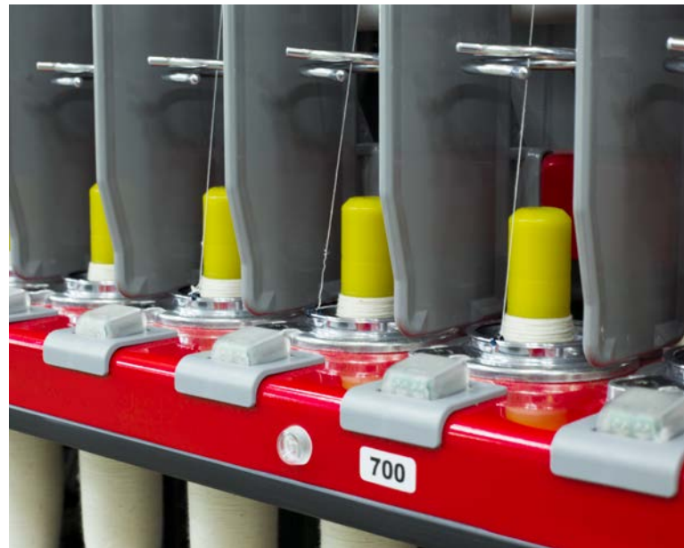
Abb. 2: Bei den Modellen G 38 und K 48 ist die Premium-Version der individuellen Spindelüberwachung ISM integriert. Das reduziert den Personalbedarf.
