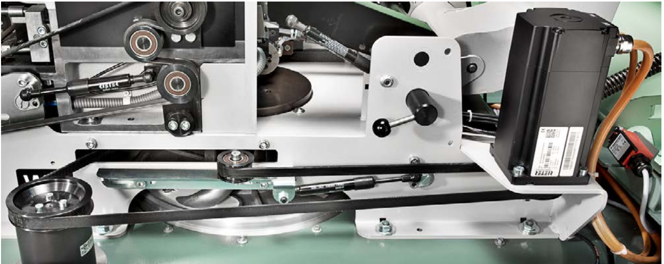
Fig. 2: El servomotor de la devanadora permite optimizar rápidamente la velocidad.
