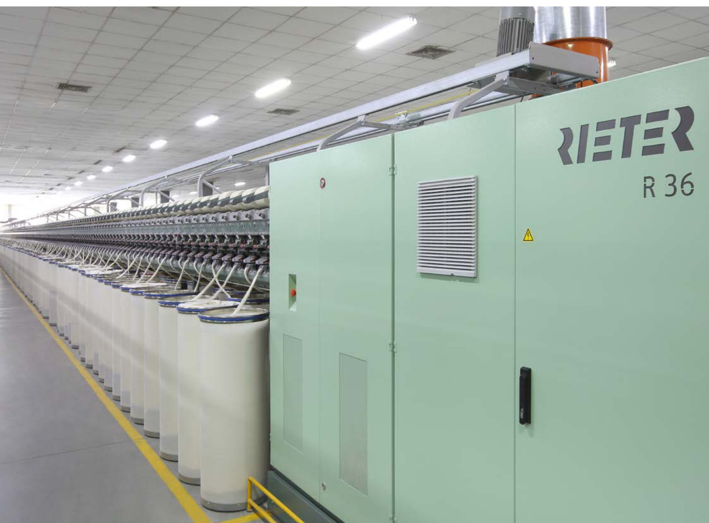
Fig. 1: La elección correcta para el cliente de Rieter Shangshui Xianghu: Máquina de hilatura a rotor R 36
