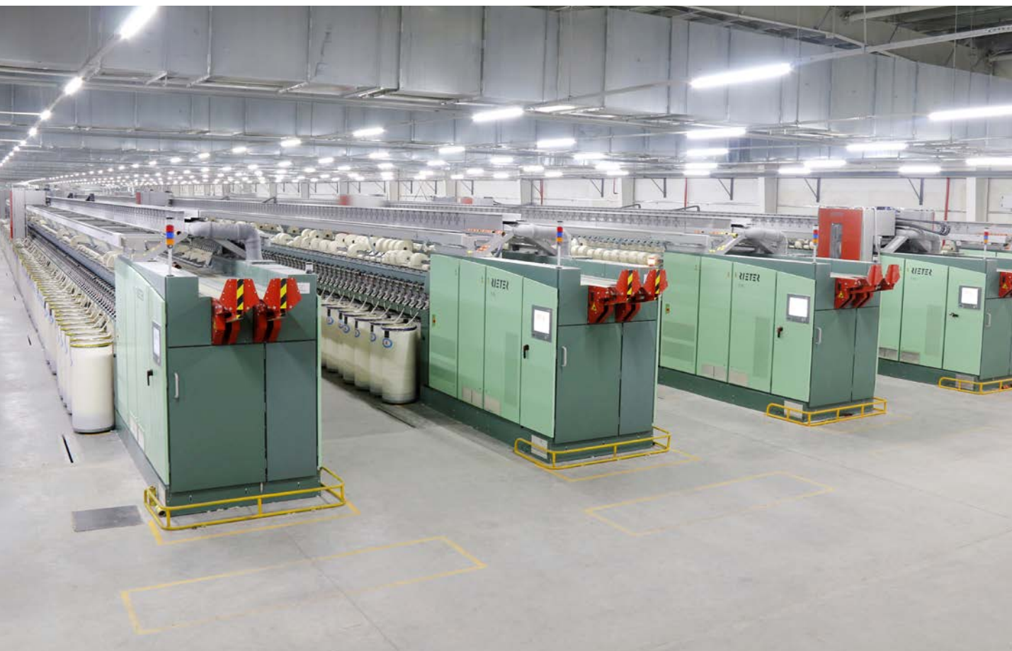
Fig. 1: Las máquina de hilatura a rotor R 66 de Rieter en Xinjiang Kangruixin Textile Co. Ltd. garantizan hilo de tejido suave y costos de producción bajos
