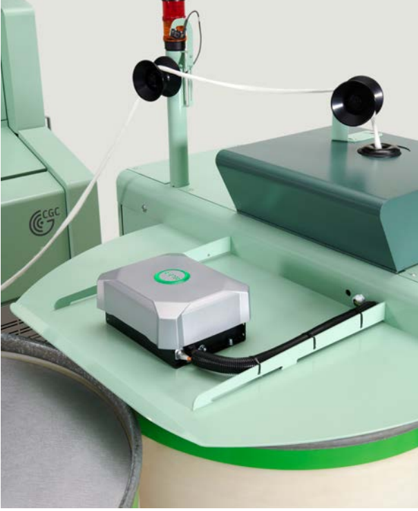
Şek. 2: Tarağın şerit istifleme bölümünde çepel seviyesi monitörü
