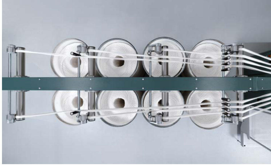
Şek. 2: Daha fazla mukavemet için güçlendirilmiş motorlu çağlık
