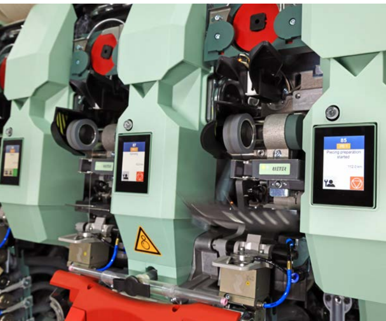
Şek. 4: Kolay işletim – eğirme ünitesi başına bir ekran
