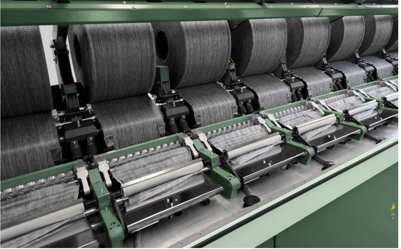
Şek. 2: Rahatsız edici kısa elyaf ve nepler tarak E 90 ile taranıp çıkarılır.
