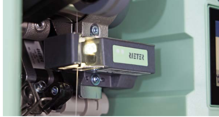
Şek. 5: İplik temizleyici Q 30A – hava jetli eğrilmiş iplikler için etkin kalite kontrolü
